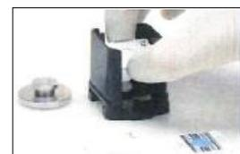
3. Positionner le **poids** au-dessus et remettre le tout dans l'analyseur.
